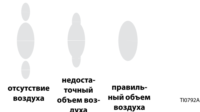
Рис. 6. Проблемы с формой окрасочного факела
